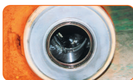
การพันเคลือบ WC ด้วยเปลวความร้อน
