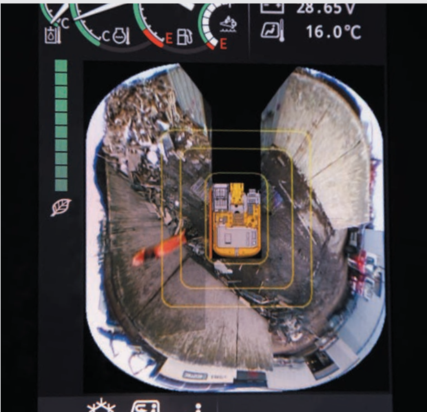
ระบบกล้องมองรอบคัน AERIAL ANGLE (อุปกรณ์เสริม) ระบบกล้องมองภาพรอบทิศทางแบบมุมมองจากด้านบน 270 องศา ช่วยเพิ่ม ทัศนวิสัยรอบเครื่องจักร มองเห็นพื้นที่ทำงานได้ชัดเจนยิ่งขึ้น เพื่อความปลอดภัย สูงสุดในการปฏิบัติงาน
