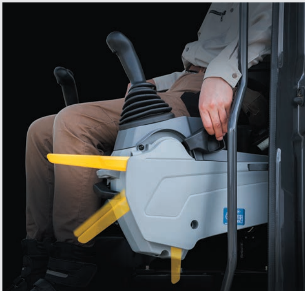
คันควบคุมปิดระบบเซฟตี้ลือคตีไฮนใหม่ คันควบคุมระบบเซฟตี้ลือคตีไฮนใหม่ได้รับการออกแบบให้ล็อกและปลดล็อกได้สะดวก ยิ่งขึ้น ด้วยการขยับเพียงข้อมือเดียว เพิ่มความคล่องตัวและความปลอดภัยในการ ใช้งานของผู้ควบคุม
